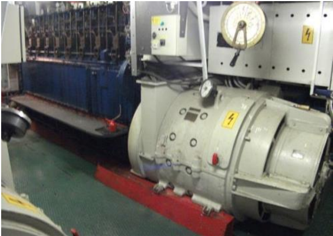
A motorok Brown Boweri generátorokat töltenek.
