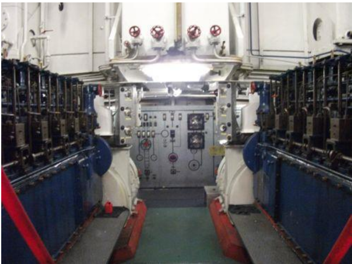
Párhuzamosan dolgozik a két 460 lóerős dízel.
