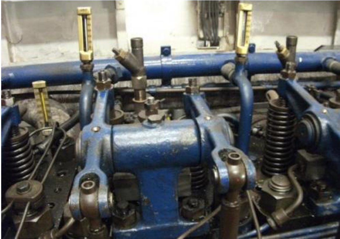
Hengerfej a hőmérőkkel és a szelephimbákkal.
